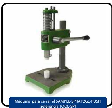
Máquina para cerrar el SAMPLE-SPRAY2GL-PUSH (referencia TOOL-SP)
