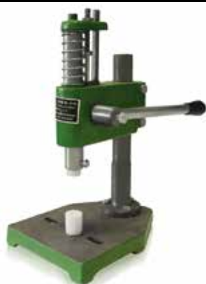
Máquina (referencia TOOL-SP) para cerrar el SAMPLE-SPRAY2GL-PUSH
