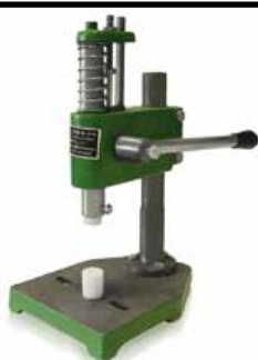
Máquina para cerrar el SAMPLE-SPRAY2GL-PUSH (referencia TOOL-SP)
